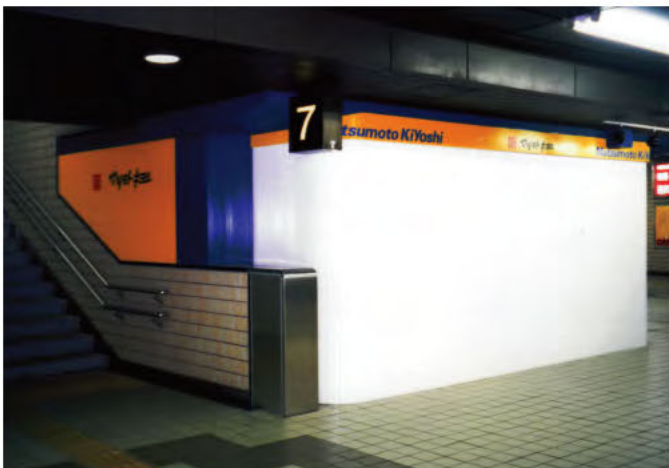
W8,000×H2,300 アルミ製(ホワイト) 手動式、片引き仕様、BOX型、曲げR=300
