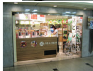
約・W3,000×H2,100 アルミ製(シルバー) 電動式、片引き仕様、BOX型
