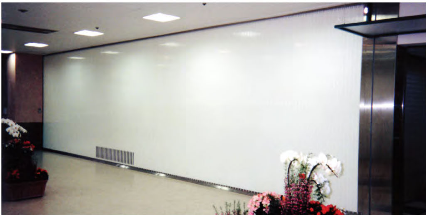
W15,000×H3,000 アルミ製(ホワイト) 電動式、片引き仕様、BOX型、フタ付き下レール仕様
