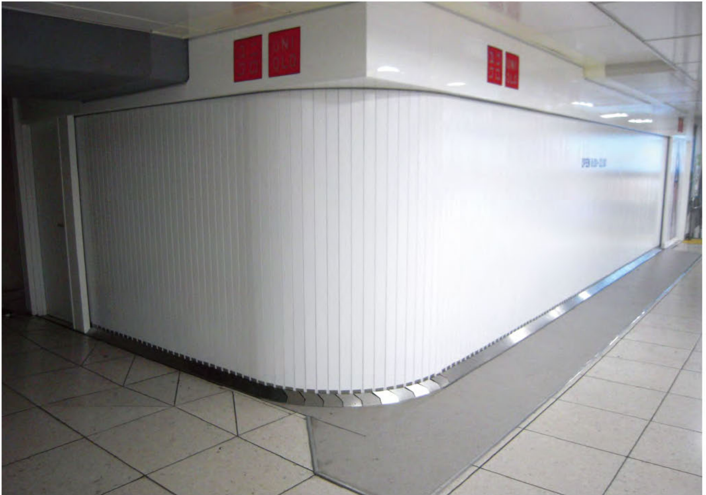
電動 W12,000×H2,200 スチール製(指定色:ホワイト)、片引き仕様、BOX型、フタ付き下レール仕様
