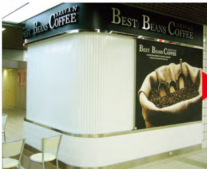
電動 W6,000×H1,500 スチール製(指定色:ホワイト)、片引き、BOX型、曲げR=450×2カ所
