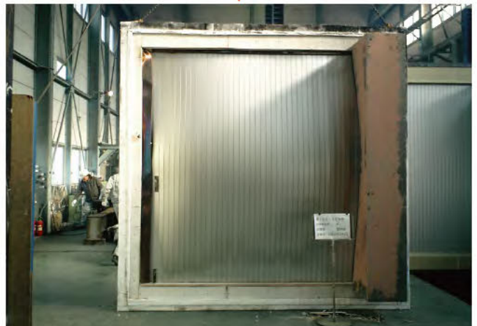
加熱試験後のシャッター
