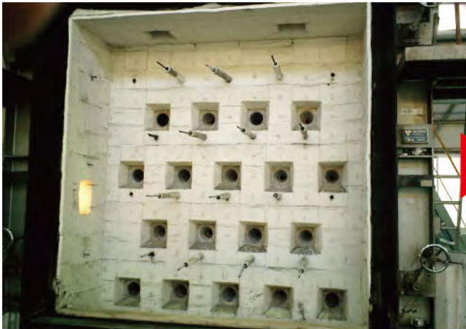
加熱試験の炉の内部
