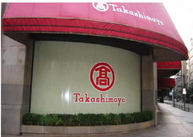
電動 W7,000×H2,700 スチール製(指定色:ベージュ)、片引き仕様、BOX型 全体R=5,000
