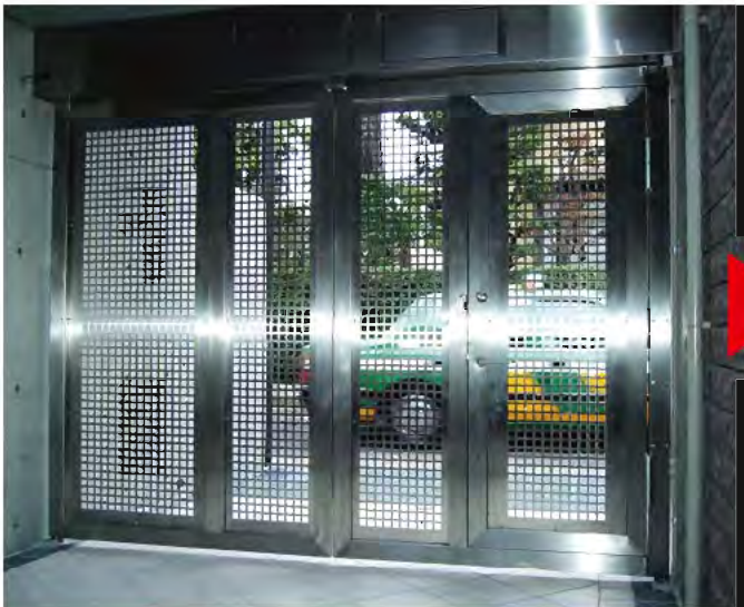
《くり戸付き》 W3,500×H2,500 ステンレス製、観音開き型、アルミンチングパネルタイプ、くり戸手動・電気錠付き、※開き戸仕様
