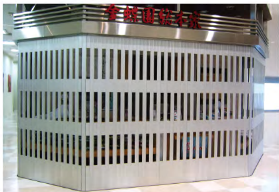
W7,300×H2,500 アルミ製(シルバー)通風タイプ 手動式、片引き、BOX型、曲げR=200×2カ所
