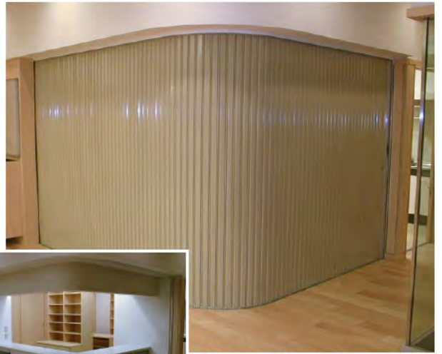
W5,500×H2,700 スチール製(ベージュ塗装) 手動式、片引き仕様、BOX型 t=0.8、防火戸仕様
