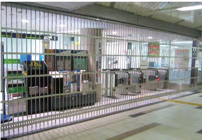
W10,000×H3,200 ステンレス製、片引き仕様、BOX型、ストレートタイプ、 下レールなし
