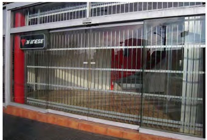
W9,000×H3,200 ステンレス製、片引き仕様、BOX型、ストレートタイプ
