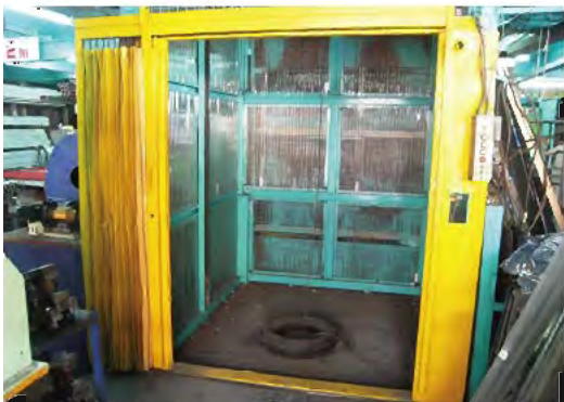
W1,800×H1,500 スチール製(イエロー) 両引き分け仕様 半透明セフティシート(イエロー)
